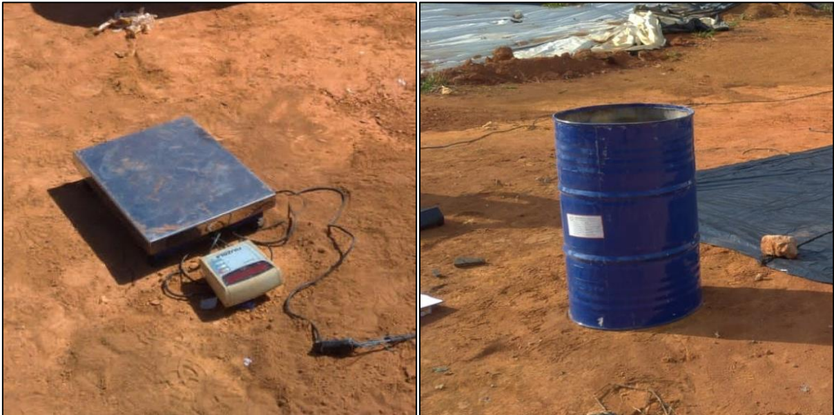
Figura 85 – Balança industrial e tambor utilizado para a caracterização física dos resíduos sólidos.
